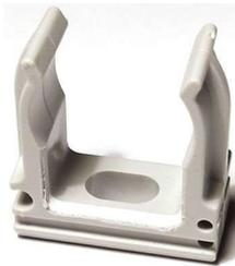
Batteriehalter für 9V-Batterie aus Klemmschelle EN20 durch Entfernen des Steges hergestellt; zusätzlich 2 Bohrungen  $\varnothing 1,5$  als Zugentlastung für Batteriekabel
