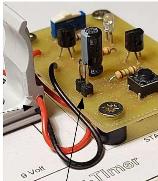
Anschluss zum Messen der Spannung am Kondensator
