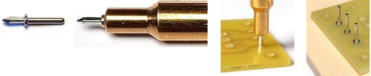
[ ] Anschließend die Lötnägel auf der Lötseite (Kupferseite) anlöten
