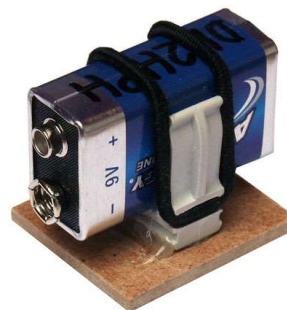
Klemmschelle auf Brettchen 45 \times 35 \times 3,5\text{mm} mit Heißkleber geklebt
