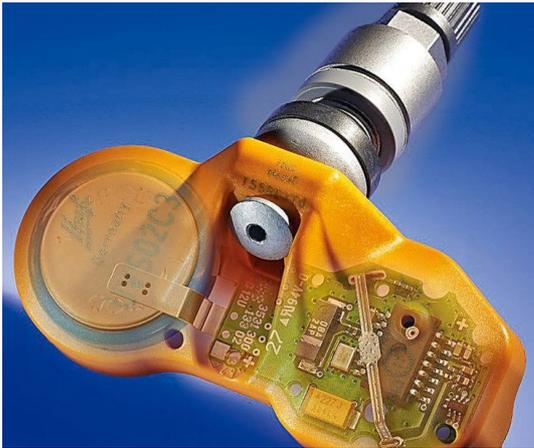
Sensor für Reifendruck-Kontrollsystem [2]
